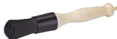
Cepillo de alta durabilidad para limpieza de partes en la industria automotriz, fabricado con fibras rígidas de PBT con terminación curva unidas con resina epóxica. Su sistema de flujo de líquidos interno, con salida entre las fibras, hacen que este cepillo se pueda utilizar con bomba de circulación para lavado con disolventes, conectado mediante una manguera a la estación de desengrase.
